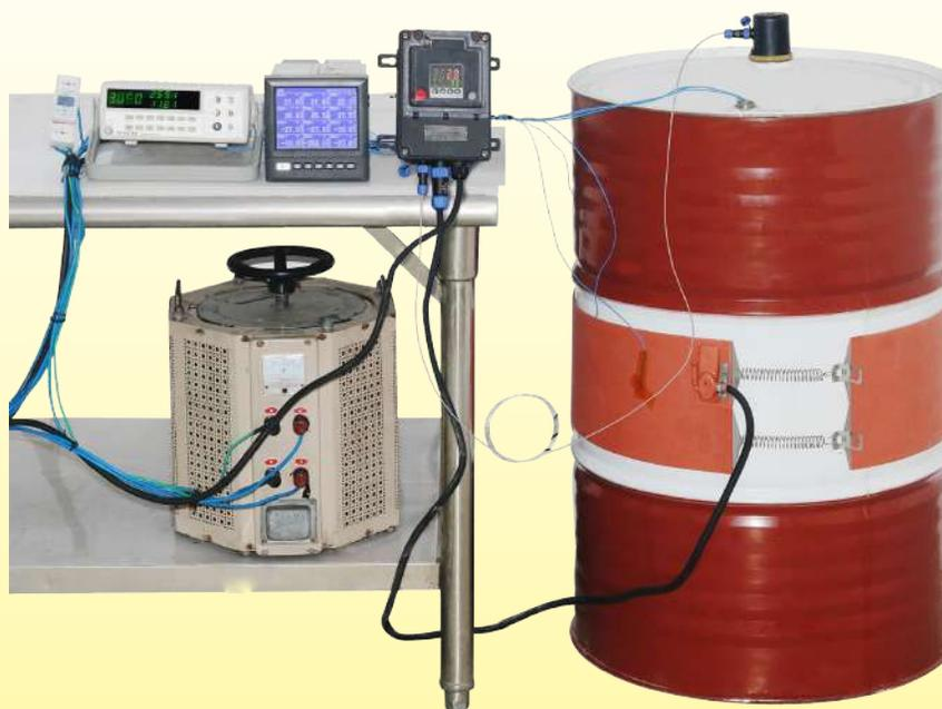
Temperaturverlauf in Abhängigkeit von der Zeit in einem 220Liter-Metallfass, gefüllt mit Wasser, beheizt durch einen Silikonheizgurt von 200mm Breite, ohne Wärmeisolation, Leistung 2250W (Oberflächenlast 0,75W/cm<sup>2</sup>).
