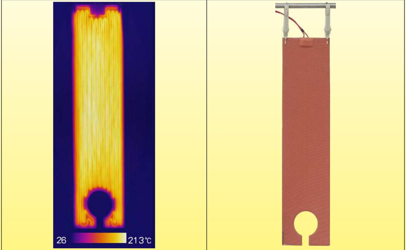
Thermografische Aufnahme einer 2,4mm flachen Silikonheizung mit einer Oberflächenlast von  $1W/cm^2$ , die in ruhiger Luft hängt, nicht auf einer Platte befestigt ist, bei einer Umgebungstemperatur von  $25^{\circ}C$ . Die Oberflächentemperatur erreicht  $213^{\circ}C$ , nahe seiner Zerstörung.
