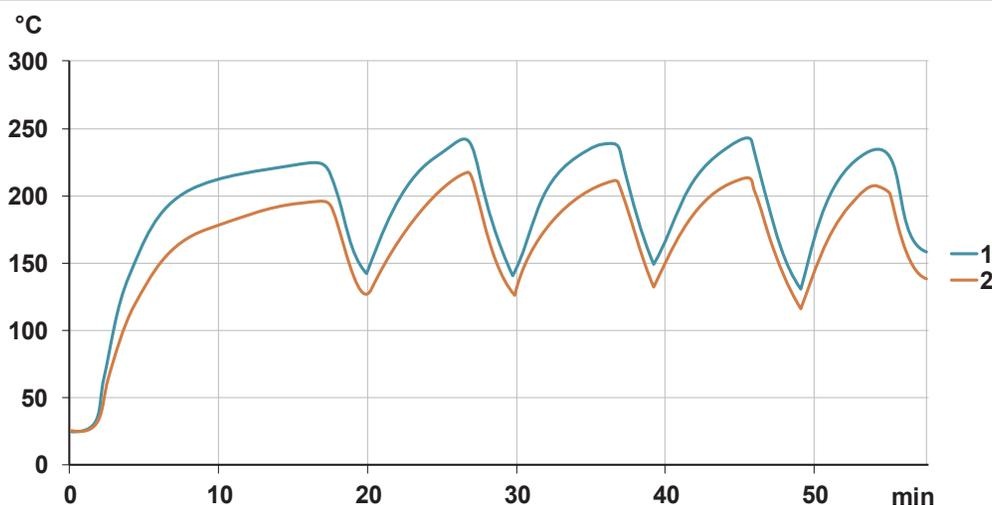
Temperaturmessung auf einem 200mm breiten Silikonurt, der auf einem 55 GAL (200 Liter) Fass montiert ist. Leistung 2250 W (0,75W/cm<sup>2</sup>), PID-Regler mit Sensor in der Mitte des leeren Tanks. Die Oberflächentemperatur wird durch einen Scheibenthermostat auf 190°C begrenzt.
