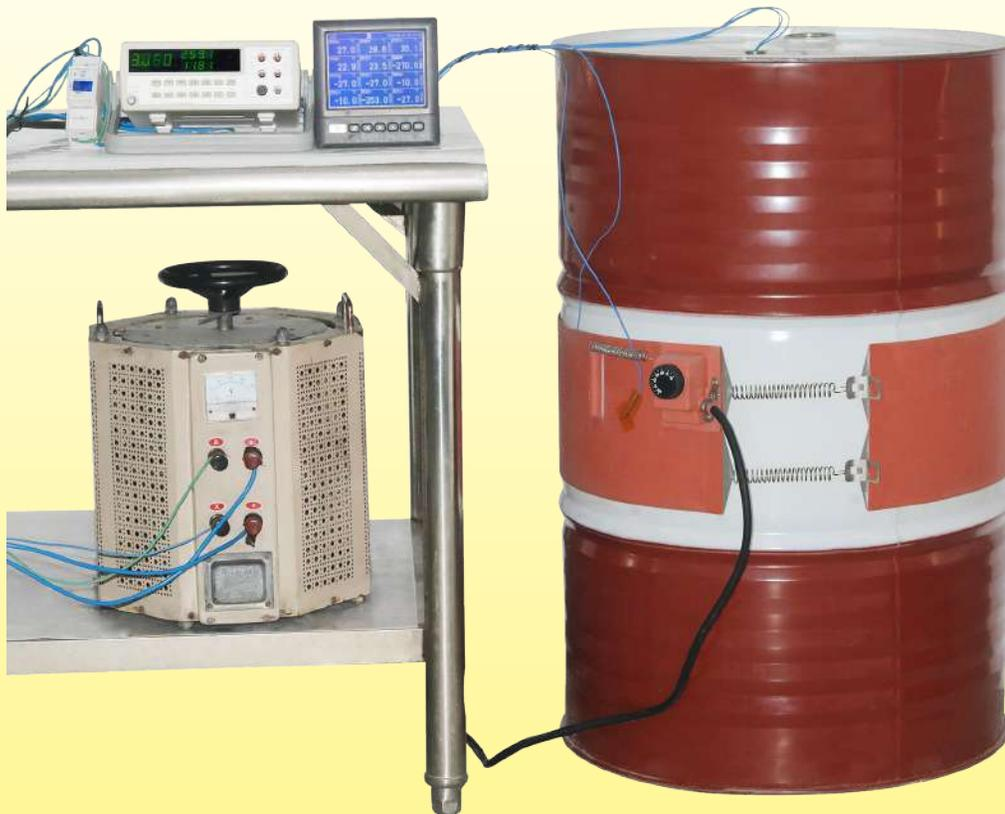
Temperaturverlauf in Abhängigkeit von der Zeit in einem 220Liter-Metalfass, gefüllt mit Wasser, beheizt durch einen Silikon-heizgurt von 200mm Breite, ohne Wärmeisolation, Leistung 2250W (Oberflächenlast 0,75W/cm<sup>2</sup>).
