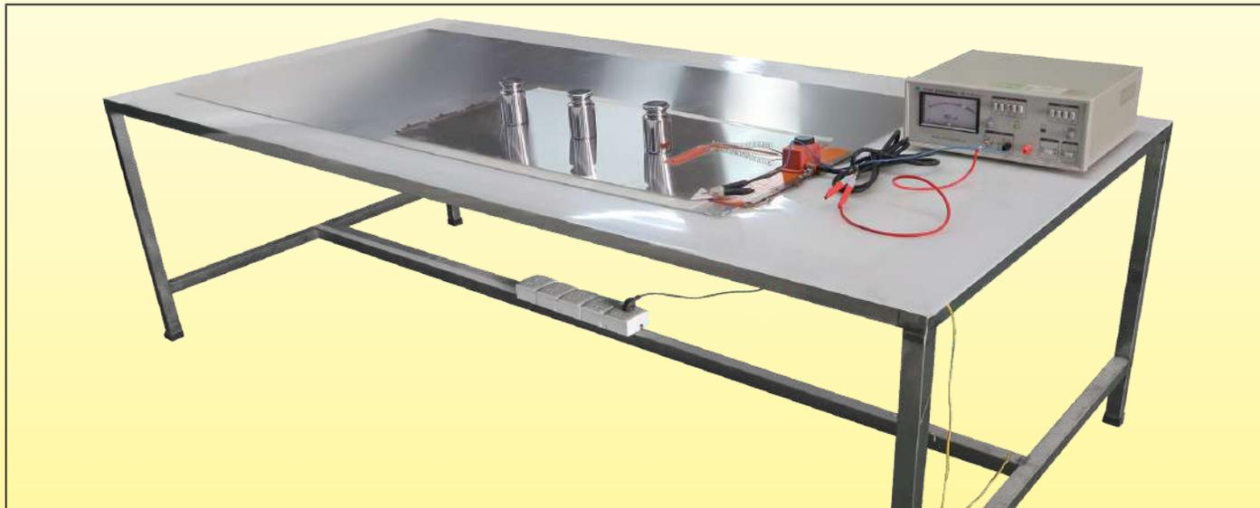
Gerät zur Messung des Isolationswiderstandes.
